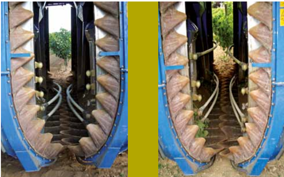
Figura 3.5. El número y colocación de los sacudidores fue variable (ver tablas 3.5 y 3.6). Los sacudidores se ajustaron de modo que la zona golpeada fuera el tronco de la cepa, usando dos sacudidores, 2+0, (imagen izquierda) y en ciertos tratamientos la pared vegetativa o canopy por encima siempre de la zona de racimos, usando tres pares de sacudidores, 2+1 (imagen derecha)
