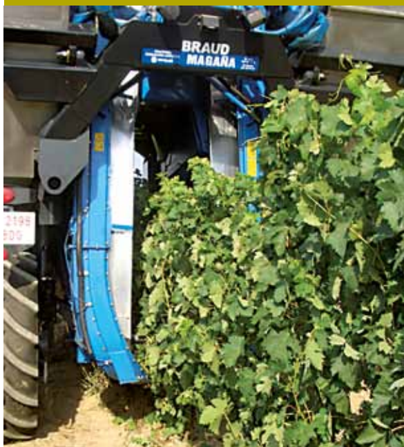
Figura 3.2. Aclareo manual de racimos (izquierda). Aclareo mecánico con máquina vendimiadora (derecha).
