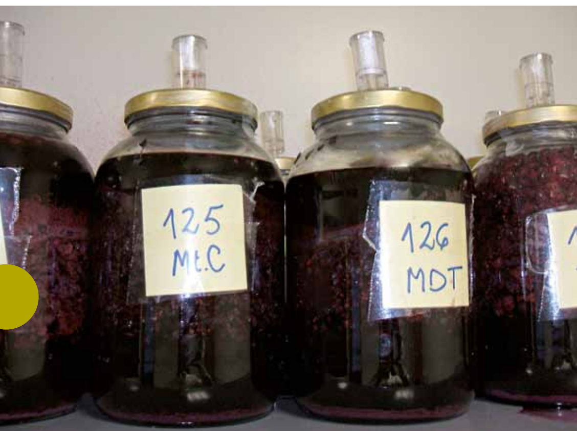
Figura 3.6. Micro-depósitos de fermentación utilizados en las vinificaciones experimentales. Diseño adaptado de Sampaio et al., (2007).
