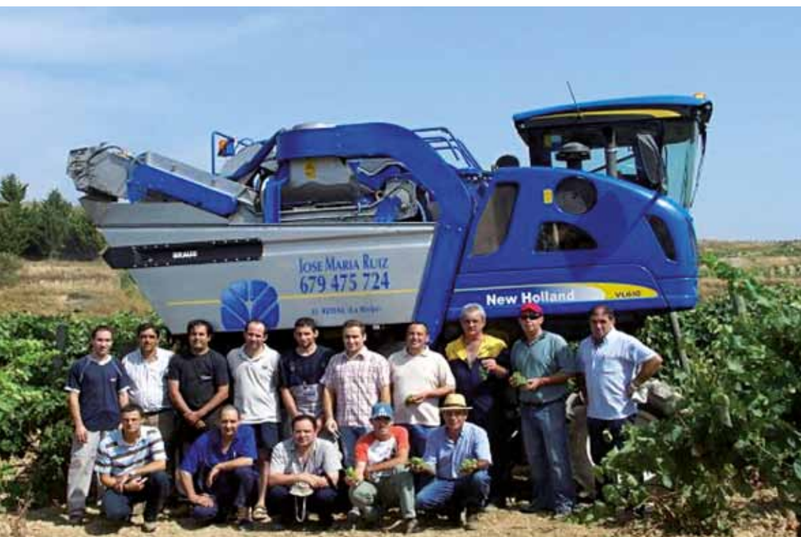
Figura 1.6. Primeros ensayos a nivel mundial sobre el aclareo mecánico por vibración en viñedos en espaldera realizados en La Rioja en julio de 2006 por investigadores de la Universidad de La Rioja, usando una vendimiadora convencional.
