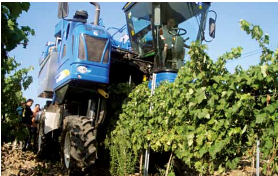
Figura 3.3. El aclareo mecánico por vibración se realizó mediante una vendimiadora mecánica automotriz convencional (New Holland®, modelo VL610, Francia) en viñedos de Tempranillo y Garnacha conducidos en espaldera.
